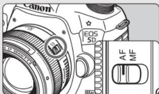
**Positionnez le sélecteur de mode de mise au point de l'objectif sur <AF>** (p.39).
