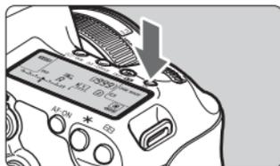
Activez (☀6)/désactivez l'éclairage de l'écran LCD en appuyant sur la touche <☀>. Pendant une pose longue, enfoncer à fond le déclencheur désactivera l'éclairage de l'écran LCD.
