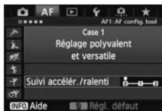
Vous permet de régler la sensibilité de suivi pour les sujets en mouvement dont la vitesse change brusquement et considérablement lorsqu'ils s'arrêtent ou démarrent brusquement, etc.
