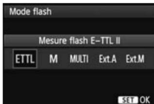
**[Mesure flash E-TTL II]** est le mode standard des flashes Speedlite de la série EX pour la prise de vue automatique avec flash.
