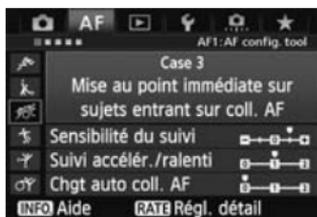
Lorsqu'un collimateur autofocus démarre le suivi du sujet, ce réglage permet à l'appareil photo de faire la mise au point sur des sujets consécutifs à différentes distances. Si un nouveau sujet apparaît devant le sujet visé, l'appareil photo démarre la mise au point sur le nouveau sujet. Également utile lorsque vous souhaitez toujours faire la mise au point sur le sujet le plus proche.
