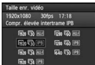
Avec [ **4** : Taille enr. vidéo ], vous pouvez régler la taille d'image, la cadence d'enregistrement des images par seconde et la méthode de compression de la vidéo. La cadence d'enregistrement des images change automatiquement selon le réglage [ **3** : Système vidéo ].
